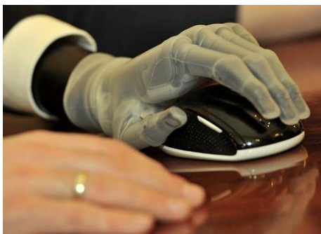
а) i-limb – протез руки под управлением смартфона
